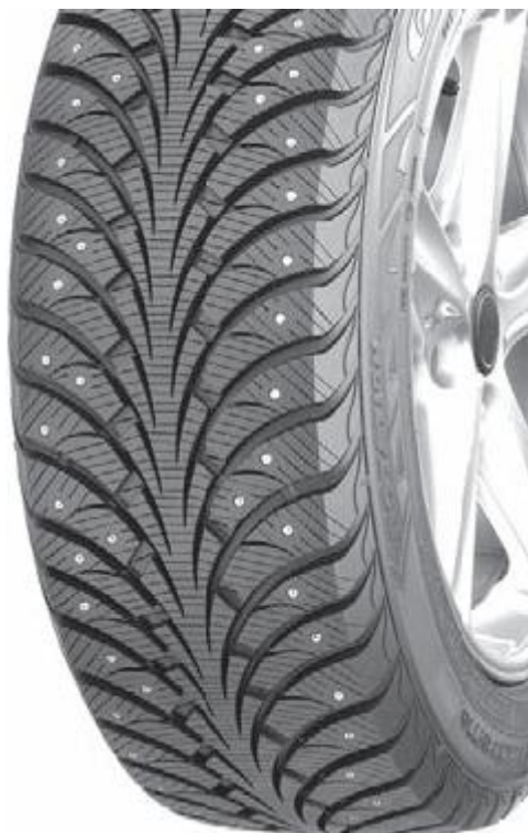
Рис. 5.4. На зимней дороге эффективна шипованная резина
